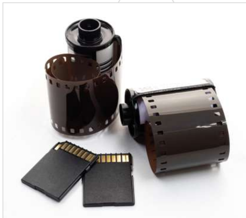
Figura 02 - Os antigos filmes fotográficos eram constituídos de películas com grânulos sensíveis à luz. Atualmente, os sensores digitais e os cartões de memória desempenham esta função de converter a luz e seus comprimentos de onda em registros elétricos digitais.
